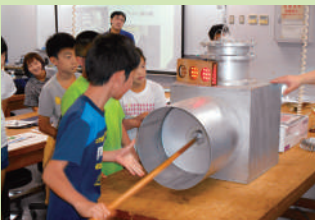
波力発電装置の模型による発電実験
